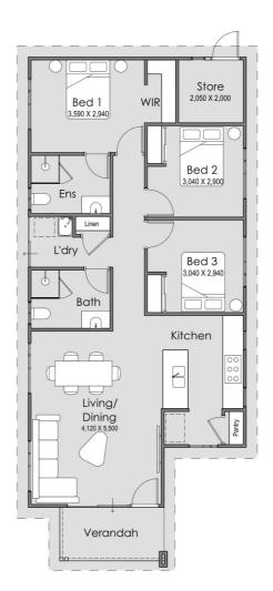
OVERALL WIDTH- 6.90m OVERALL LENGTH- 24.20m MIN BLOCK WIDTH- 10.30m MIN BLOCK LENGTH- 30m TOTAL AREA- 127.90m<sup>2</sup>
