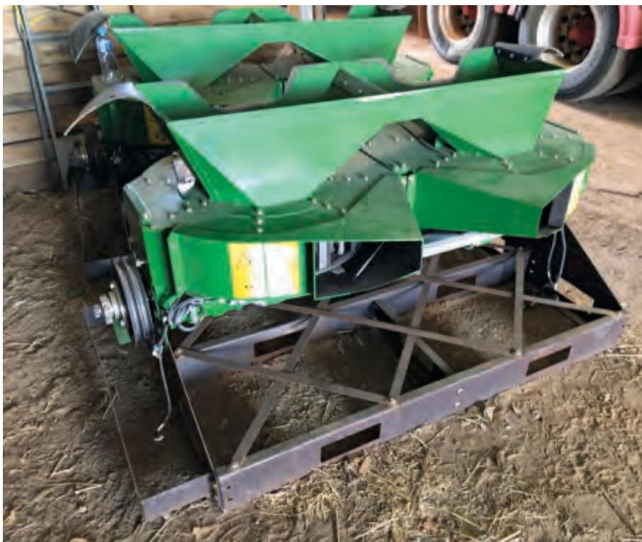
Un buen detalle es la bandeja de acero que se abulona al SCU para montar la carga, tornando el montaje y la remoción más simples y más seguros.
