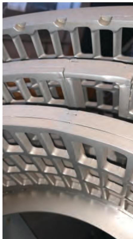
Desgaste en New Holland 8.90 tras 2500 ha de trigo con un rendimiento de 1.3 t/ha cortado por debajo de 100 mm con ingreso significativo de arena y grava agregado a la tasa de desgaste.
