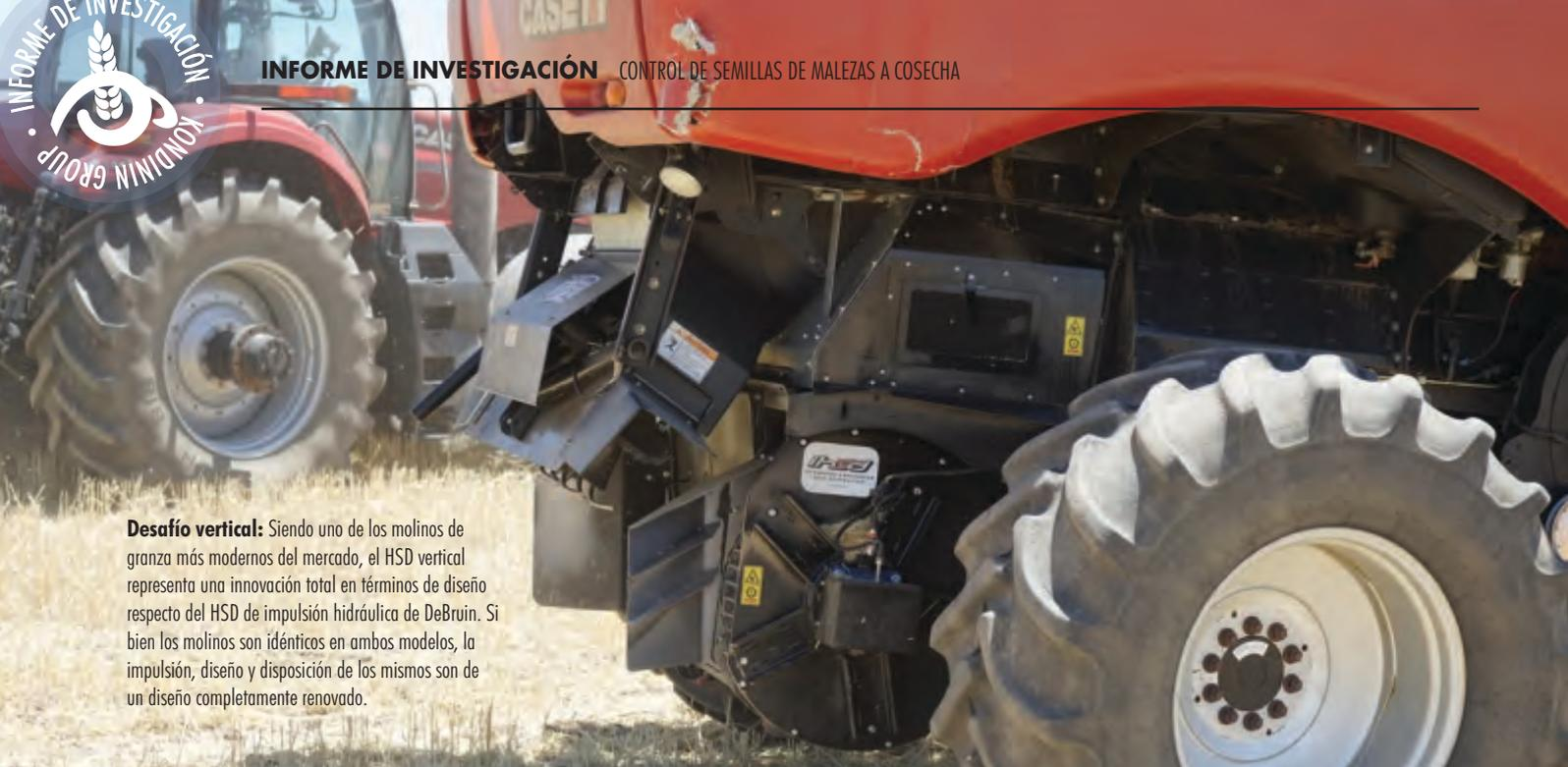
**Desafío vertical:** Siendo uno de los molinos de granza más modernos del mercado, el HSD vertical representa una innovación total en términos de diseño respecto del HSD de impulsión hidráulica de DeBruin. Si bien los molinos son idénticos en ambos modelos, la impulsión, diseño y disposición de los mismos son de un diseño completamente renovado.
