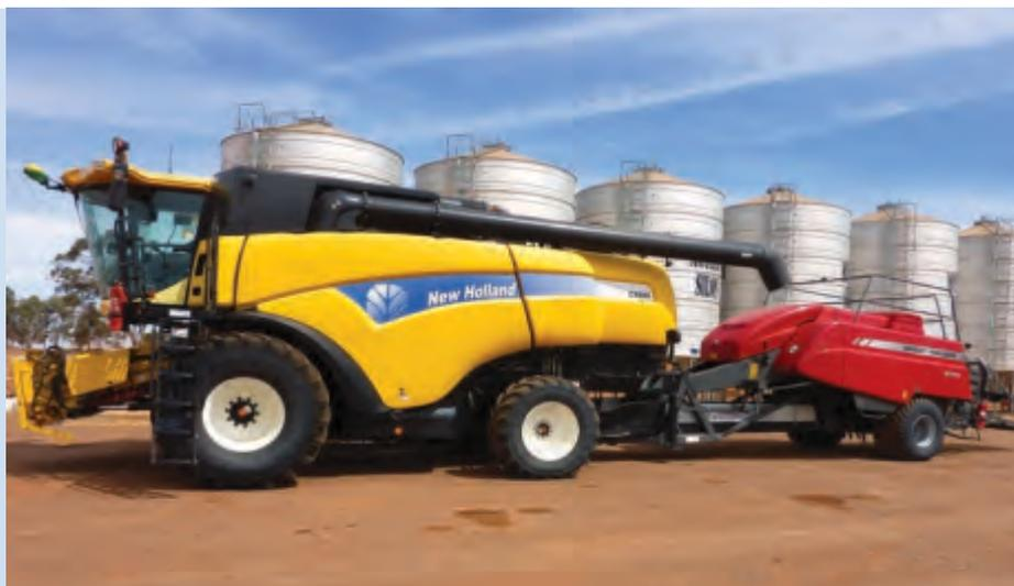
La carga de la enrolladora debe ser removida y reemplazada por una cinta transportadora para llevar la granza y la paja a la cámara de enrollado.
