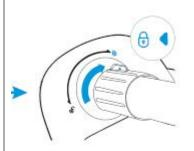
顺时针旋转导汽管固定件,凸 台对准"份"标志即可锁紧。
