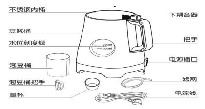
不锈钢内桶 豆浆桶 水位刻度线 泡豆桶 泡豆桶把手 量杯 下耦合器 把手电源插口 滤网 电源线
