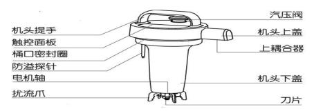
机头提手 触控面板 桶口密封圈 防溢探针 电机轴 扰流爪 气压阀 机头上盖 上耦合器 机头下盖 刀片
