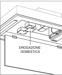
Connessioni di cablaggio
